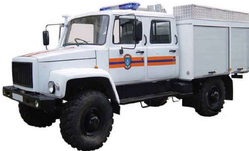
Рисунок 2 – АСА на базе шасси ГАЗ 3325
