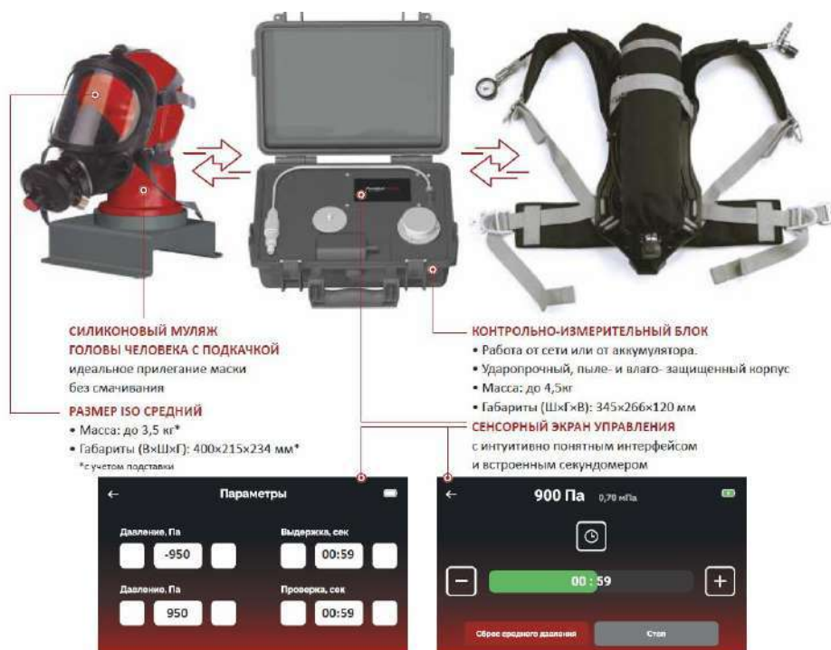
Рисунок 1 – Электронная установка «Эйр Тест 2000» для проверки статических характеристик ДАСВ
