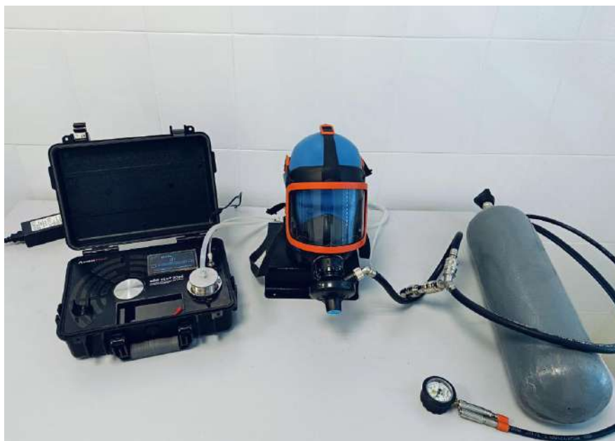
Рисунок 2 – Электронная установка «Эйр Тест 2000» на рабочем столе перед началом проведения проверок ДАСВ
