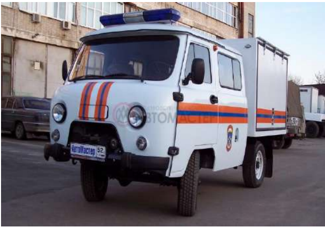
Рисунок 1 – Легкие АСА: а) на базе шасси УАЗ; б) на базе шасси ГАЗ
