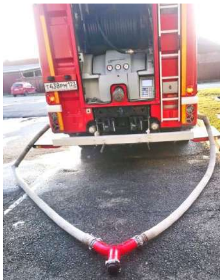
Рисунок 3 – Гидравлические испытания переходного устройства (рукавного разветвителя)
