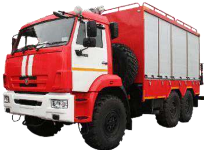
Рисунок 3 – АСА на базе шасси КАМАЗ 43101
