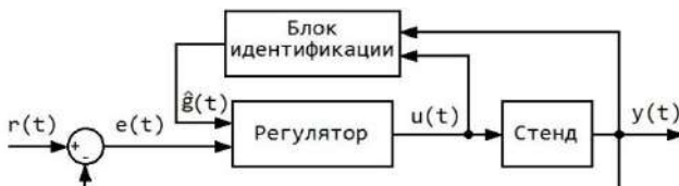
Рис. 1 – Функциональная схема адаптивной системы управления стенда прочностных испытаний
