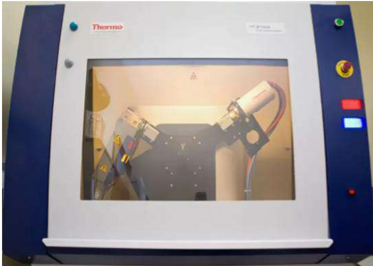
Рис. 1 – Рабочая камера дифрактометра в которой находятся гониометры с трубкой и детектором, штатив для образца, основные кнопки управления и световые элементы
