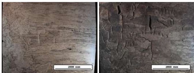
Рис.2 – Структура деформированных образцов, где: а – степень деформации 11%; б – степень деформации 23%
