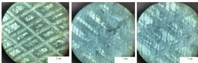
Рис. 2 – Покрытия для образца 104: эталон; дисульфид молибдена; 50% дисульфид молибдена и 50% эпилам
