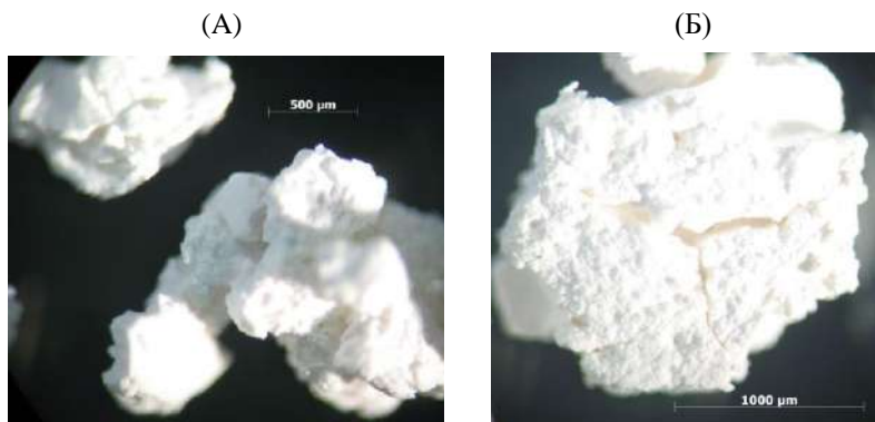
Рис. 2 – Микрофотографии ПК, содержащих (А) 56.9 и (Б) 85.4 вес.% ПЭ
