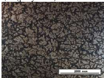
Рис.1 – Литая структура до деформации
