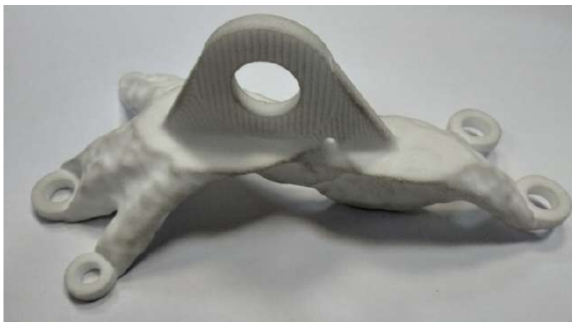
Рис.6 – Деталь, изготовленная на основе оптимизированной модели
