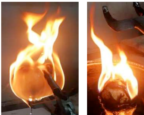
Рис. 4 – Испытание исходного ПТУ на огнестойкость
