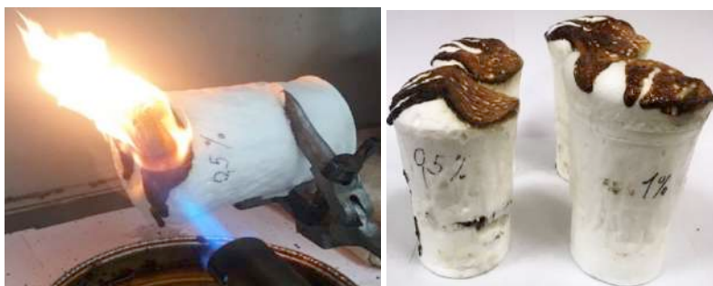
Рис. 3 – Испытание модифицированных ППУ на огнестойкость
