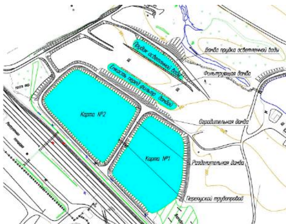
Рис. 1 - Существующая технологическая схема очистки шахтных вод шахты «Костромовская» Ленинск-Кузнецкого района Кемеровской области.
