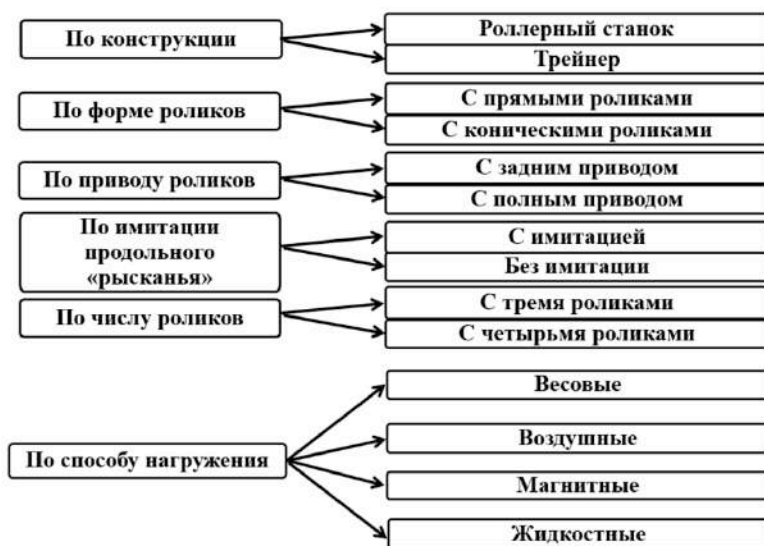
Рис. 2 - Предложенная классификация станков и нагрузочных устройств
