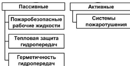
Рис.1 – Некоторые технологии обеспечения пожаро и взрывобезопасности гидрофицированных машин
