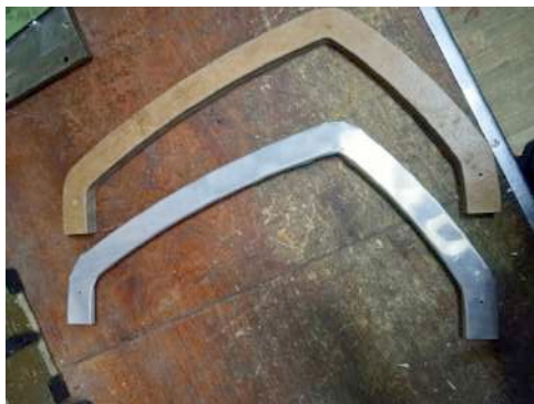
Рис 3 – Пуансон и готовый шпангоут
