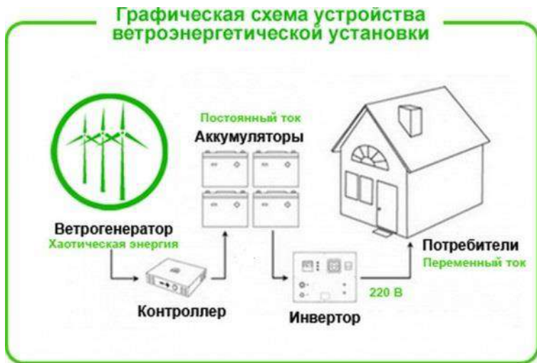
Рис. 1 - Схема автономной ВЭУ.
