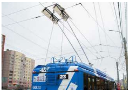
Рис.2 – Автоматическое подключение токоприемников к контактной сети при помощи «ловушки»
