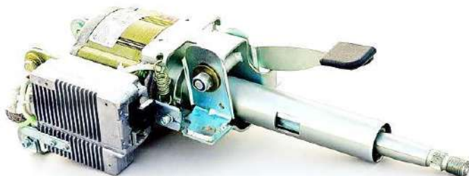
Рис. 2 - Безредукторный ЭМУР колонного типа, выпускаемый АО «Автоэлектроника» (г. Калуга)
