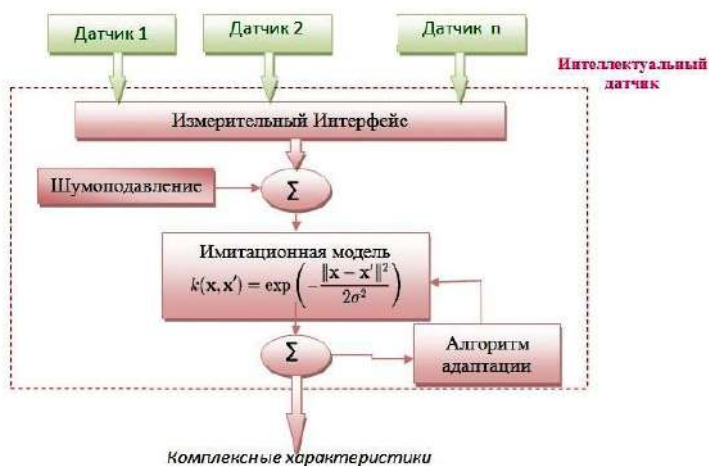
Рис. 1 - Интеллектуальный датчик диагностики уровня превышения ЭМП от системы зажигания
