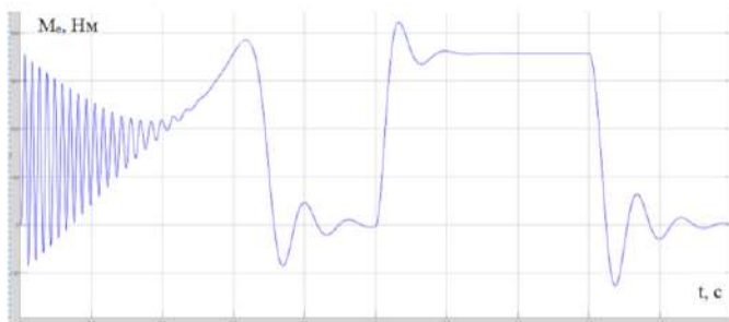
Рис. 4 – график переходных процессов электромагнитного момента M_e(t) АД
