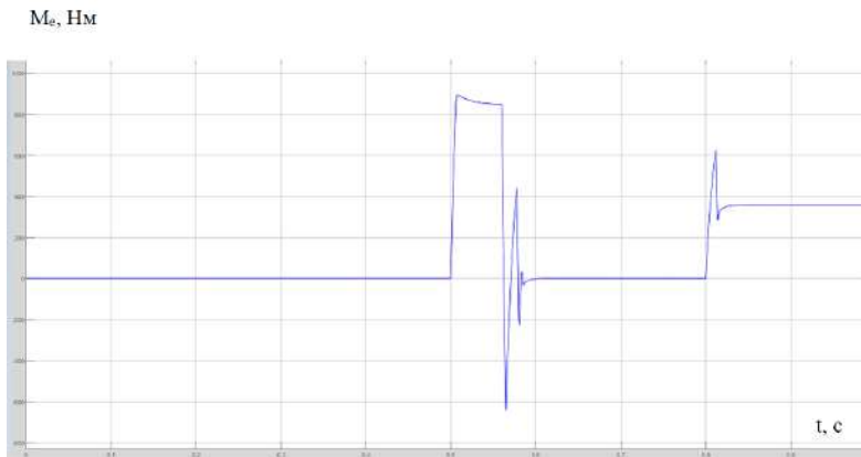
Рис. 6 – график переходных процессов электромагнитного момента M_e(t) САУ АД в СПР
