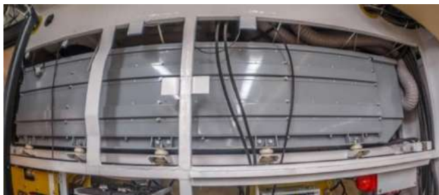
Рис.1 – Литий-титанатные аккумуляторы в задней части электробуса
