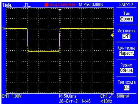
Рис. 3 – Результаты измерений длительности импульса
