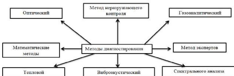
Рис. 3 – Структурная схема методов диагностирования
