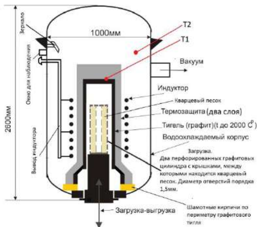
Рис.2 – Эскиз вакуумной печи с индуктором
