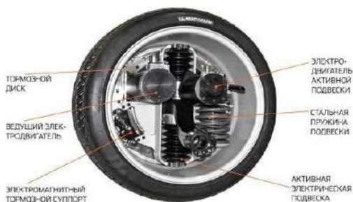
Рис. 1 – конструкция мотор-колеса
