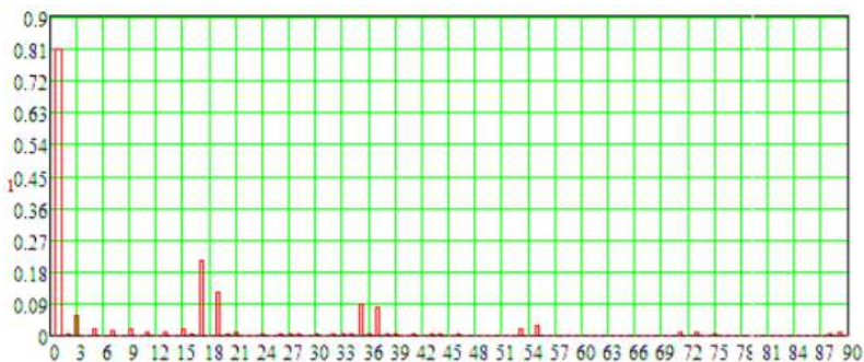
Рис.1- Амплитуда гармоник в воздушном зазоре
