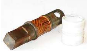
Рис. 1.7 – Внешний вид датчика момента с ферромагнитной пленкой
