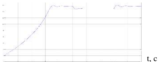
Рис. 3 – График переходных процессов скорости вращения вала \omega(t) АД
