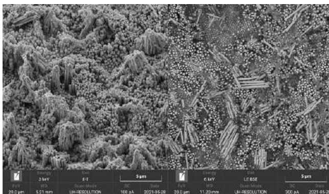
Рис.2 – Снимки СЭМ модифицированных палладием никелевых наноструктур
