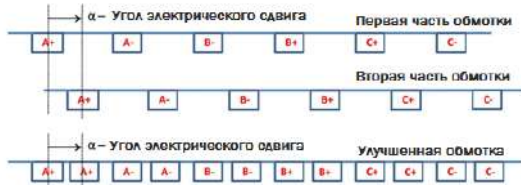
Рис. 1 – Общий принцип реализации сдвига части обмотки
