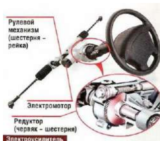
Рис. 1 - Схема рулевого управления редукторного ЭМУР колоночного типа
