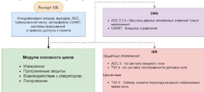
Рис. 2 – Алгоритм работы установки магнитно-импульсной обработки
