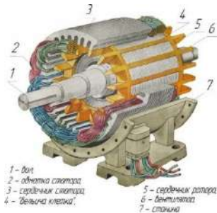
Рис. 1 - Устройство асинхронного двигателя с короткозамкнутым ротором
