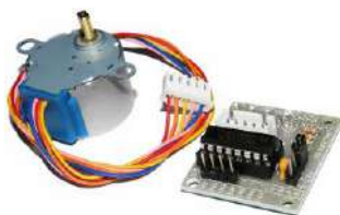
Рис. 1 – Конструкция шагового электродвигателя и платы управления
