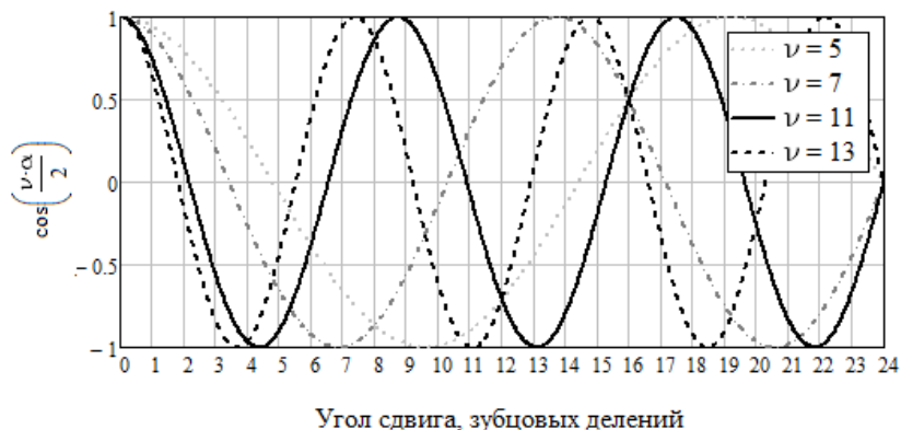
Рис. 2 – Зависимость изменения обмоточного коэффициента \nu -й гармоники от угла сдвига в зубцовых делениях
