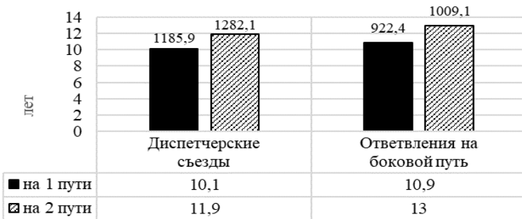
Рисунок 2 – Средний жизненный цикл ( T_{cp} ) стрелочных переводов проекта 2750
