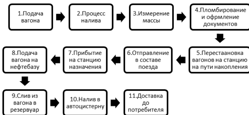
Рисунок 2 – Процесс транспортировки груза в вагоне-цистерне
