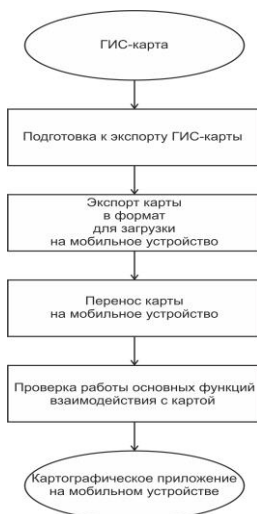
Рисунок 1 – Технологическая схема экспорта ГИС-карты на мобильное устройство
