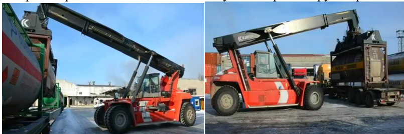
Рисунок 1 – Перестановка танк контейнера с железнодорожной платформы на автомобильную
