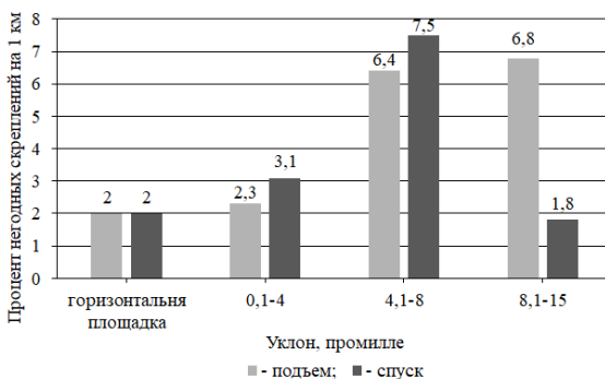
Рисунок 2 – Гистограмма зависимости негодности креплений от продольного профиля
