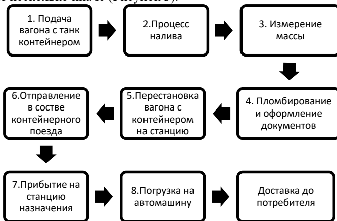
Рисунок 3 – Процесс транспортировки груза в специализированном контейнере (танк-контейнере)
