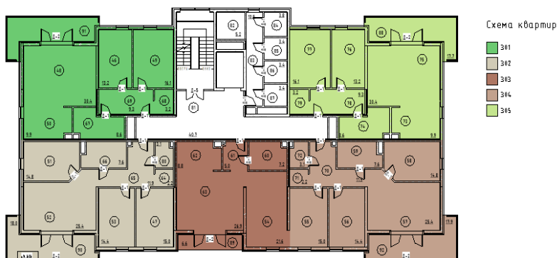
Рисунок 1 – Расположение квартир типового этажа
