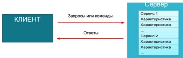
Рис. 3 – Архитектура GATT (General Attribute Profile)
