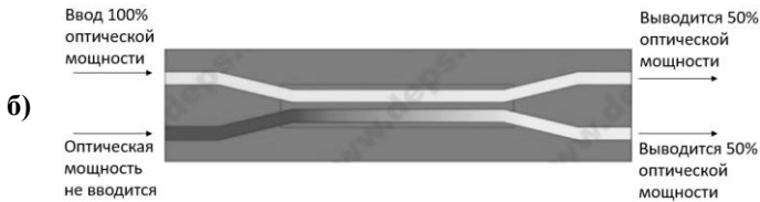
Рис. 2 – Делители: а) на взаимосвязанных линиях; б) X – делитель [5]
