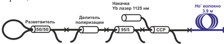
Рис. 1 – Схема волоконного гольмиевого лазера с самосканированием длины волны.
