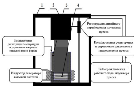
Рис. 1- Блок-схема экспериментального стенда высокотемпературного синтеза интерметаллида под давлением при непрерывном нагреве порошковой смеси исходных элементов в стальной пресс-форме: рабочее пространство гидравлического пресса, 2 - главный цилиндр пресса, 3 - стальная прессформа, 4 – гидравлический пресс
