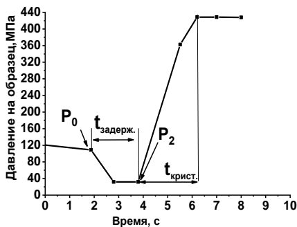
Рис. 2 – диаграмма “давление-время” процесса высокотемпературного синтеза интерметаллида Ni_3Al под давлением, где P_0 – величина предварительного давления, t_{\text{задерж.}} – время задержки включения рабочего хода плунжера пресса после самовоспламенения исходной порошковой прессовки, t_{\text{крист.}} – время кристаллизации продукта синтеза, P_2 – давление на продукт высокотемпературного синтеза
