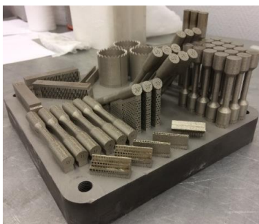
Рис. 2 – Вид цилиндрических образцов на платформе построения
