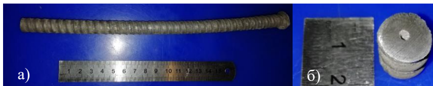
Рис. 2 – Внешний вид УВК лигатур: боковая поверхность (а) и поперечный срез (б)
