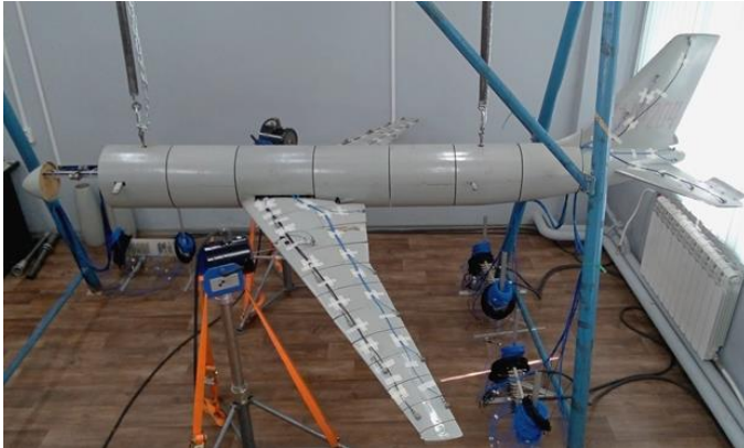
Рис. 3 – Динамически подобная модель самолета Ту-204
