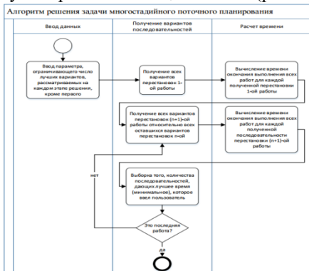
Рис. 1 – Схема алгоритма решения задачи многостадийного поточного планирования в нотации BPMN
