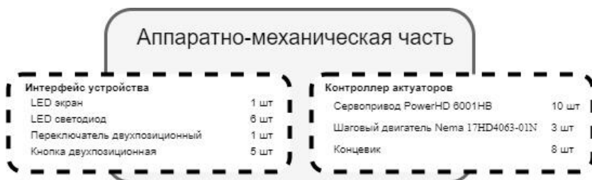
Рис. 2 – Структурная схема аппаратно-механической часть УНИ
