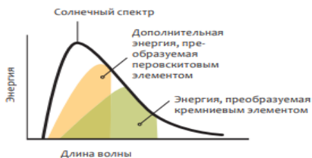
Рис. 2 – Преобразование света перовскитом и кремнием в разных участках спектра
