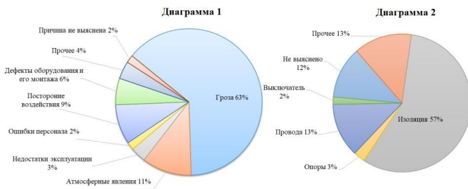
Рис. 1 – Статистика основных причин отказов (диаграмма 1) и статистика по виду отказавших функциональных узлов ВЛ-35 кВ (диаграмма 2)
