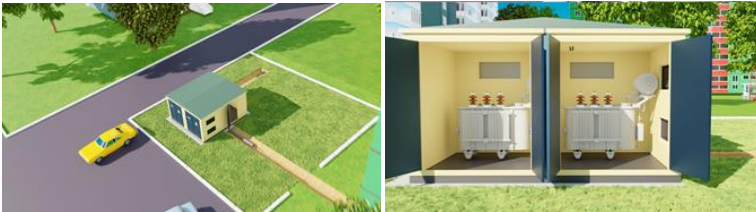
Рис. 1 – Иллюстрация трансформаторной подстанции 10/0,4
