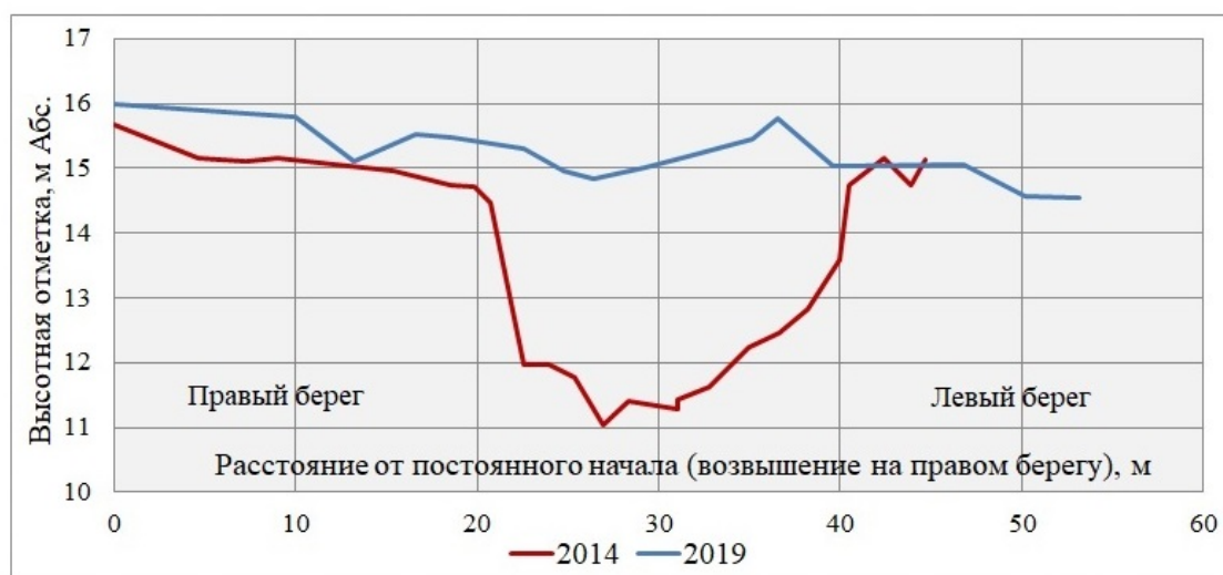
Рис. 1. Совмещенные продольные профили входного створа правобережного залива Другалка (залив отделился к 2018 г.)
