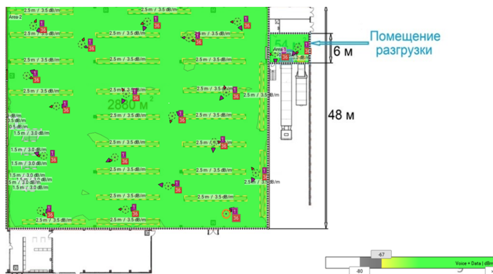
Рис. 1. Моделирование зоны покрытия беспроводной сети в программе Ekahau Site Survey Pro
