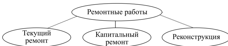
Рис. 1. Классификация ремонтных работ
